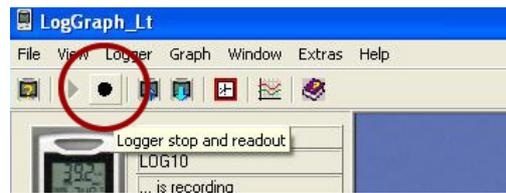
Slika 9. - Ikonica za zaustavljanje snimanja data loggera i očitavanje podataka
